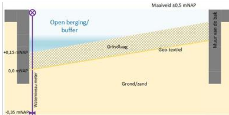
Figuur 13.1: Doorsnede en opbouw infiltratiesysteem (niet op schaal)
